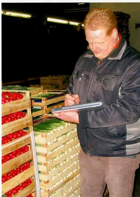
Warenwirtschaftssystems stets auf neueste Technologien. So entwickelte Brückner eine erweiterte Softwarelösung für den Fahrverkauf. Mit MDE-(Mobile Daten Erfassungs-)Terminals ist es möglich, per WLAN-Funkverbindung zu einem auf dem Fahrzeug installierten Drucker direkt Lieferscheine oder Rechnungen auszudrucken. Ebenso lässt sich so auf gespeicherte Auftragsdaten zugreifen, z. B. um Aufträge zu verändern.
